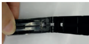
2. Decape o revestimento da fibra
